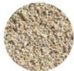
Place de midi Revêtement perméable
